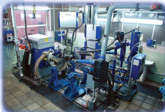
Испытательный стенд с системой автоматизации PUMA, AVL, Австрия
